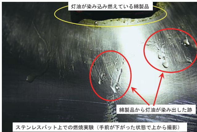
第6-21図 灯油を含浸させた綿製品から燃焼中に灯油が染み出てきた状況
